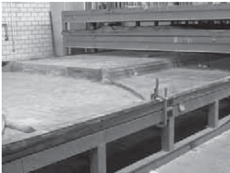
Figura 2.3 La pressa sotto vuoto, pur non raggiungendo altissime pressioni, garantisce omogeneità e costanza di pressione durante tutta la fase di pressatura.
